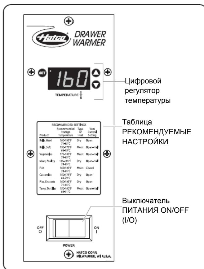
Панель управления с цифровым регулятором температуры
