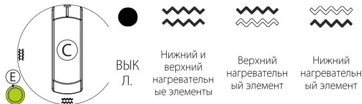
Повернуть ручку «D» термостата на величину, соответствующую желаемой температуре приготовления. Включение оранжевой светодиодной лампы «F» указывает на работу нагревательных элементов.
