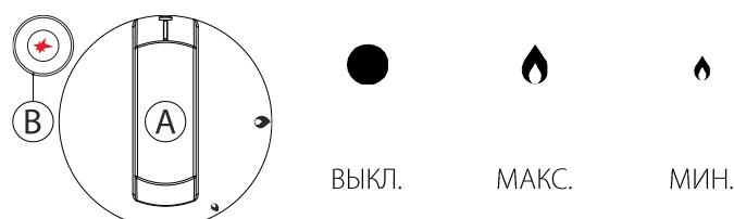
**!** Если пьезоэлектрическое устройство окажется нерабочим, розжиг можно осуществить вручную с помощью спички или газовой зажигалки.
