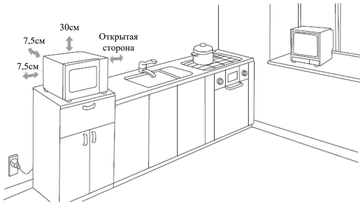
Между печью и стеной требуется зазор 3 дюйма (7,5 см). Одна сторона печи должна быть открыта.
