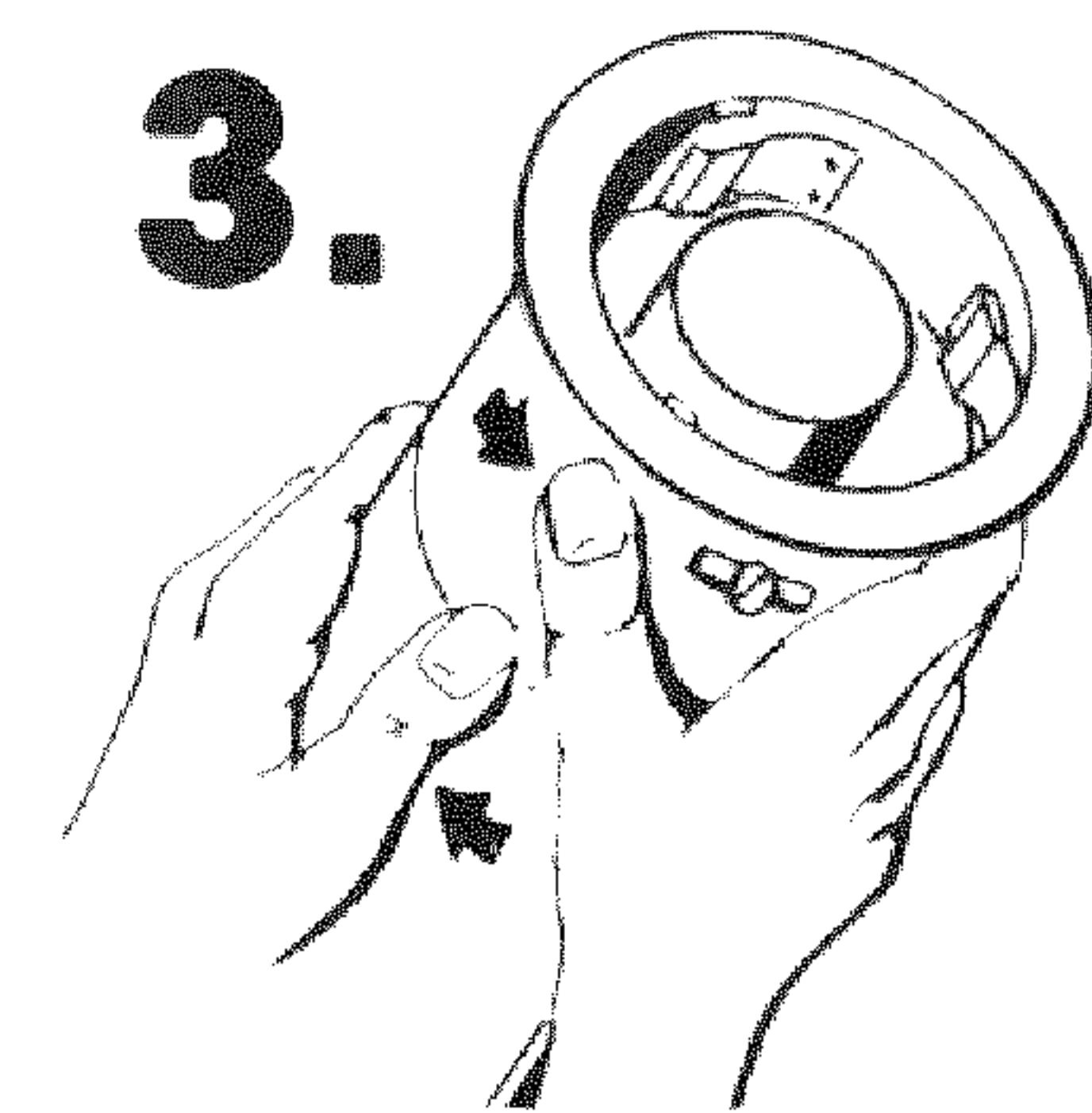
**Поворачивать шайбу** против часовой стрелки, пока настраивающий зажим не будет надежно удерживать стаканчики. Затянуть фиксирующий винт. **НЕ ПОДГИБАЙТЕ ЗАЖИМЫ ВРУЧНУЮ!**
