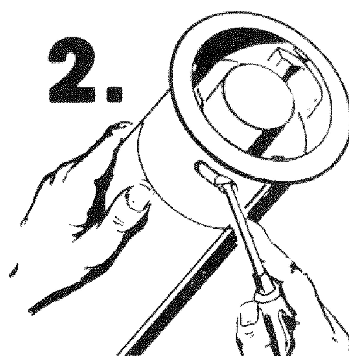
**Ослабить фиксирующий винт и загрузить** стаканчики в диспенсер.
