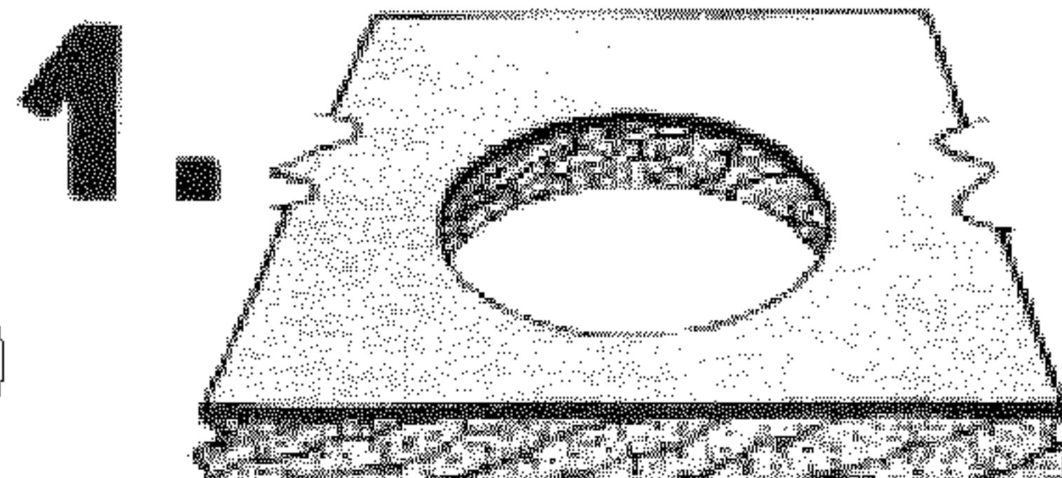
**Вырезать отверстие**, соответствующее выбранному диспенсеру. Чтобы определить требуемый диаметр отверстия, см. строку Е в таблице характеристик.
