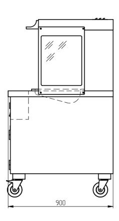
Поддержание температуры картофеля фри в зоне хранения осуществляется за счет инфракрасных нагревателей установленных сверху над зоной хранения и нагревательного кабеля установленной под зоной хранения.
