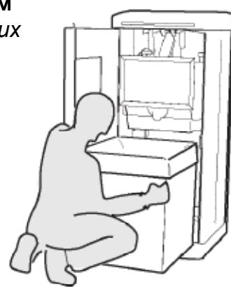
Загрузочный люк автоматически запирается. Датчик движения отключается. Этот сигнал сообщает о том, что необходимо заменить мешок. Отоприте и откройте дверцу и замените мешок. При необходимости очистите желоб и плиту пресса. Заприте дверцу. Храните ключи отдельно от машины.
